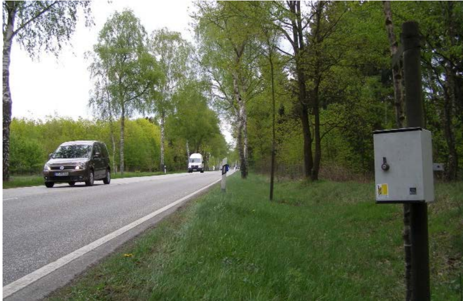
Abb. 3-4: Seitenradargerät an Teststrecke.
